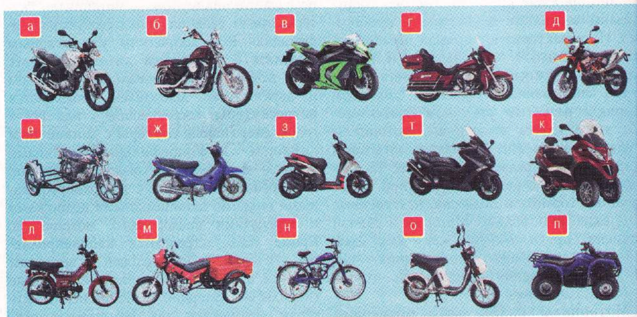
Рис. 1.2. Основные виды мототехники на российском рынке: а – классик; б – круизер; в – спортбайк; г – турер; д – эндуро; е – мотоцикл с боковым прицепом; ж – скутеретта; з – 50-кубовый скутер; и – макси-скутер; к – трехколесный скутер; л – мопед; м – трехколесный мопед; н – мотовелосипед; о – электробайк; п – квадрицикл
