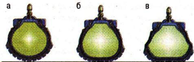
Рис. 7.1. Оценка давления в шине по ее деформации (мотоцикл стоит на колесах, водитель сидит на месте): а – давление избыточное, шина перекачена; б – давление в норме; в – давление пониженное, шина полуспущена
