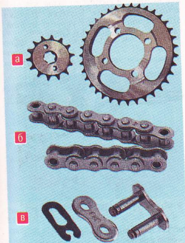
Рис. 3.20. Элементы цепной передачи: а – ведущая и ведомая звездочки; б – цепь; в – замок цепи
