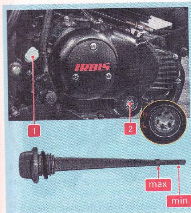
Рис. 2.37. Контроль уровня масла: 1 – с помощью щупа; 2 – через специальное контрольное отверстие
