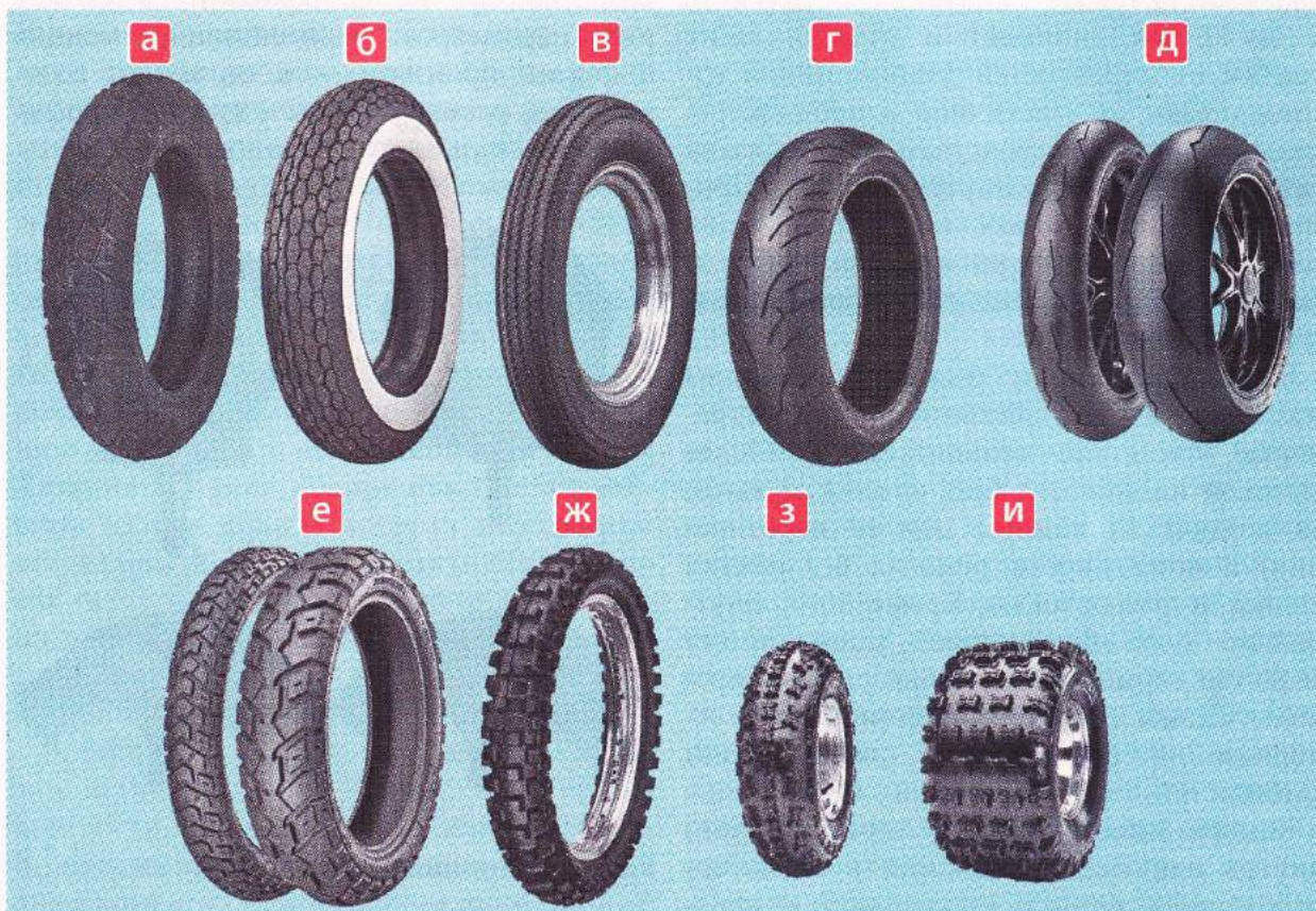
Рис 4.17. Виды протектора шин мототехники разных классов: а – дорожный универсальный; б – ретро-типа; в – дорожный переднего колеса «классика» и мопеда; г – дорожный шоссейный; д – гоночный; е – мотоцикла двойного назначения; ж – внедорожный; з – переднего колеса квадрицикла; и – заднего колеса квадрицикла
