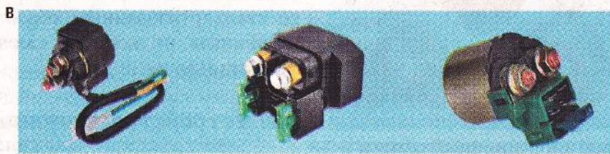
Рис. 6.27. Схема включения электростартера: а – на мотоциклах и мопедах; б – на скутерах; в – вид реле стартера; 1 – кнопка электростартера на руле; 2 – электростартер; 3 – реле стартера; 4 – обмотка реле; 5 – замок зажигания; 6 – предохранитель; 7 – аккумуляторная батарея; 8 – контакты реле, замыкающие силовую цепь стартера; 9 – концевой выключатель переднего тормоза; 10 – концевой выключатель заднего тормоза
