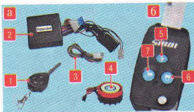
Рис. 6.25. Распространенная мотоциклетная противоугонная сигнализация: а – вид компонентов; б – пульт управления; 1 – ключ зажигания с пультом; 2 – блок управления; 3 – соединительные провода; 4 – автономный сигнал; 5 – кнопка дистанционного включения электростартера; 6 – кнопка включения противоугонной сигнализации; 7 – кнопка отключения сигнализации
