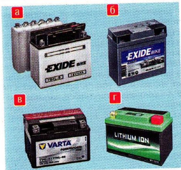
Рис. 6.1 Виды мотоциклетных аккумуляторных батарей: а – свинцово-кислотная обслуживаемая; б – необслуживаемая гелевая; в – необслуживаемая, изготовленная по технологии AGM; г – литий-ионная
