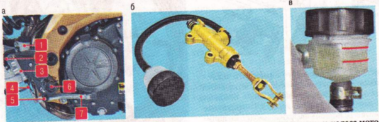
Рис 5.6. Главный тормозной цилиндр гидравлического дискового тормоза заднего колеса мотоцикла: а – расположение на мотоцикле; б – главный тормозной цилиндр с бачком; в – бачок с метками максимального и минимального уровней тормозной жидкости; 1 – бачок; 2 – шланг; 3 – главный тормозной цилиндр; 4 – регулировочный шток; 5 – ось тормозной педали; 6 – подножка; 7 – тормозная педаль
