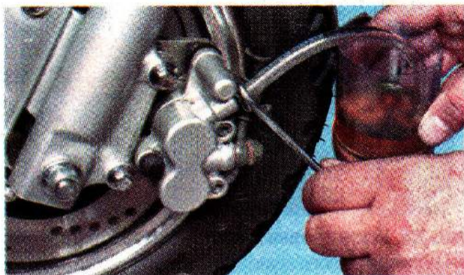
Рис. 7.6. Прокачка гидравлического привода дискового тормоза
