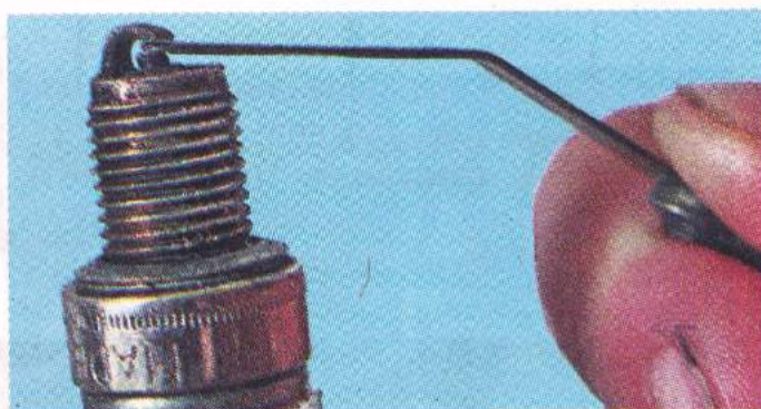
Рис. 7.17. Измерение зазора между электродами свечи
