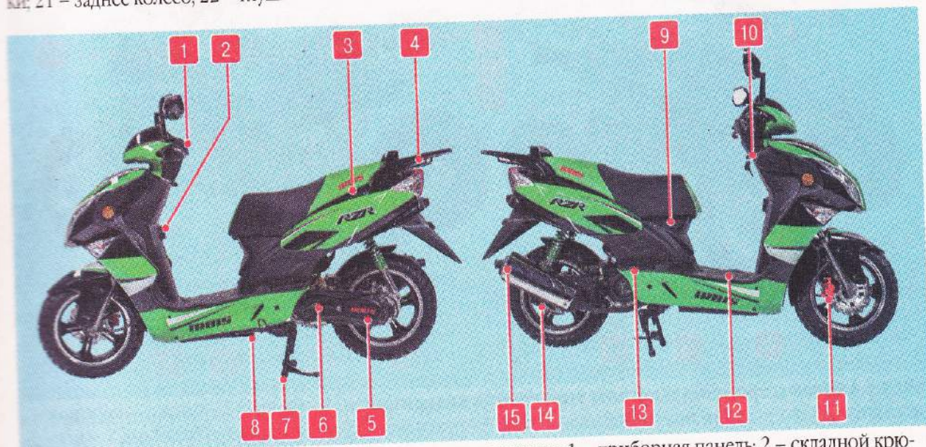
Рис. 1.3. Общее устройство и органы управления мотоцикла: 1 – фара, указатели поворота; 2 – приборная панель и замок зажигания; 3 – руль, органы управления, пульта, зеркала заднего вида; 4 – топливный бак; 5 – карбюратор; 6 – задний фонарь, указатели поворота; 7 – место для набора инструментов; 8 – цепной привод колеса; 9 – рама; 10 – боковой упор; 11 – рычаг переключения передач; 12 – двигатель; 13 – тормоз переднего колеса; 14 – сиденье; 15 – топливный бак; 16 – телескопическая вилка; 17 – переднее колесо; 18 – педаль тормоза заднего колеса; 19 – рычаг кик-стартера; 20 – амортизатор задней подвески; 21 – заднее колесо; 22 – глушитель
