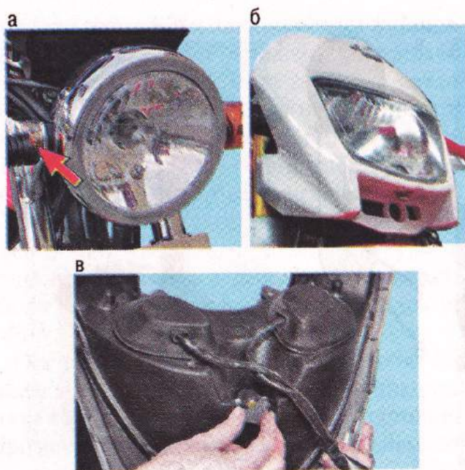
Рис. 7.15. Регулировка света фары: а – поворотом фары вокруг оси (показана стрелкой); б – смещением оптического элемента после выворачивания болта-фиксатора (показан стрелкой); в – смещением оптического элемента поворотом регулировочного винта (показан стрелкой)
