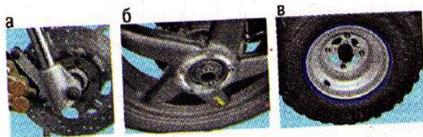
Рис. 4.15. Способы крепления колес: а – гайкой на неподвижной оси; б – гайкой на вращающейся оси с использованием пружинной шайбы; в – гайками к ступице
