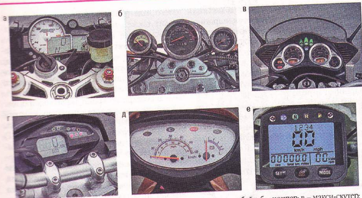
Рис. 1.9. Примеры исполнения приборных панелей: а – спортбайк; б – чоппер; в – макси-скутер; г – эндуро; д – электроскутер; е – квадрицикл
