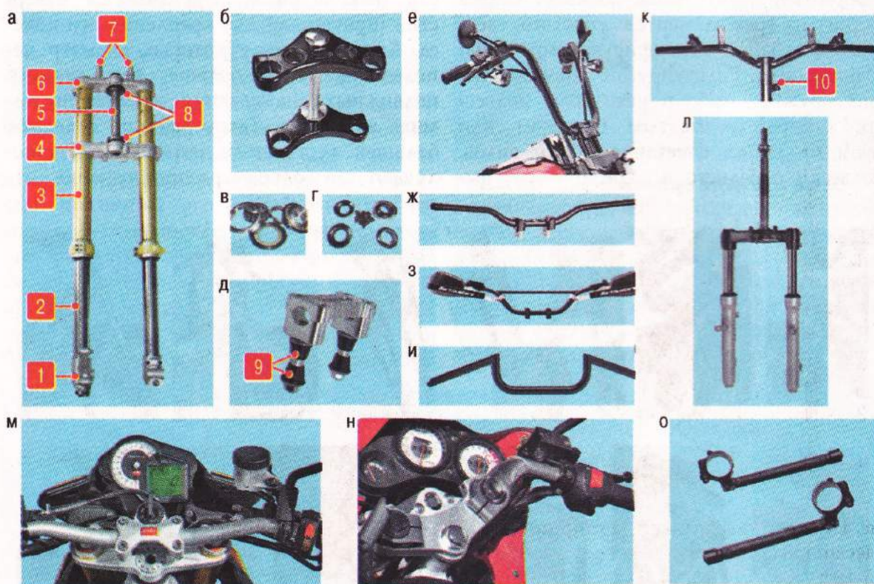
Рис. 4.5. Элементы телескопической вилки: а – телескопическая вилка (на фото перевернутого типа); б – нижняя и верхняя траверсы; в – роликовые конические подшипники рулевой колонки; г – шариковые упорные подшипники; д – крепления руля; е – высокий руль мотоцикла чоппера; ж – низкий руль; з – руль внедорожного мотоцикла с перемышкой; и – руль кастома; к – руль скутера; л – вилка скутера с одним нижним мостиком; м – крепление руля к верхней траверсе; н – крепление частей руля (клипонов) к перьям вилки; о – клипоны; 1 – проушины для оси колеса; 2 – подвижные трубы вилки; 3 – неподвижные трубы; 4 – нижняя траверса; 5 – стержень; 6 – верхняя траверса; 7 – кронштейны для руля; 8 – подшипники рулевой колонки; 9 – виброгасящие резиновые втулки; 10 – зажимной кронштейн крепления руля скутера
