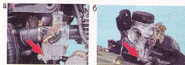
Рис. 2.26. Карбюраторы с ускорительными насосами (отмечены стрелками): а – золотникового, б – типа CV
