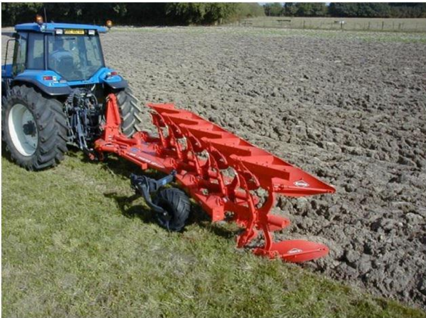
Плуг, на который установлены полувинтовые корпуса.
