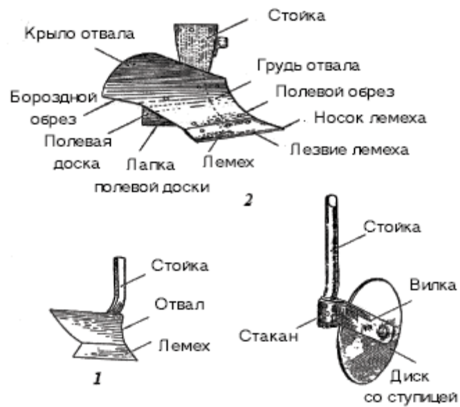
Рис. 2. Составные части плуга
